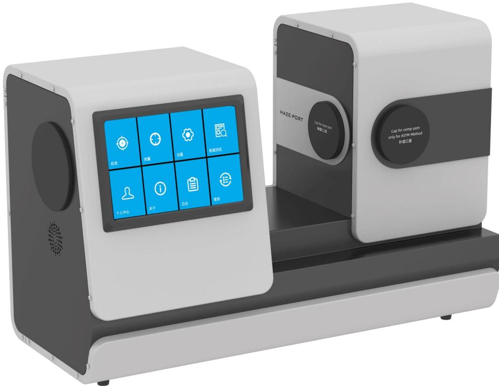
可见-红外波段光谱雾度计 CS-730 专业应用于盖板玻璃、光学薄膜、镜片、扩散板、透明包装等领域的雾度、透过率、光谱透过率、清晰度、色度检测,其波长范围 400-1100nm , 1nm 超高分辨率,可精准测量光谱数据。140mm 超宽样品池设计,方便放置不同规格样品。7 英寸触摸显示屏,操作直观便捷。
